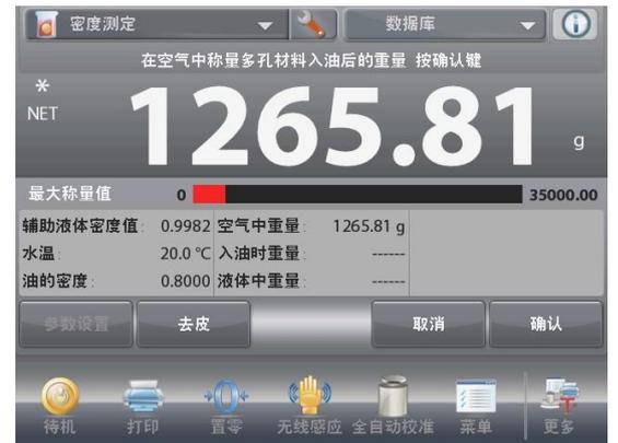
**3個步驟的第3步**——浸油樣品浸入液體中進行稱量。
