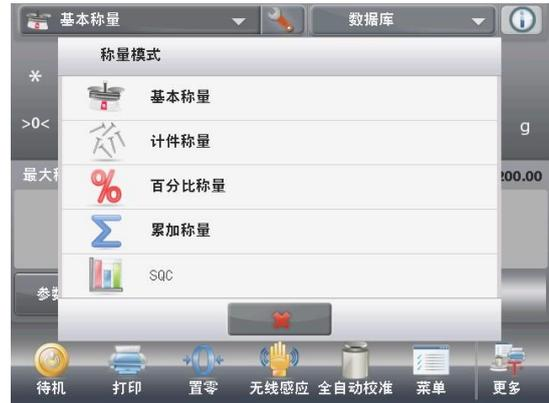
注意：如果稱量模式沒有在清單中出現，必須在功能表的稱量模式中將其開啟。在進入功能表的稱量模式頁面，選擇您想開啟的稱量模式。然後在這個稱量模式的設置功能表中開啟——以下範例為百分比稱量。所有開啟的稱量模式將出現在主頁面的稱量模式功能表中。
