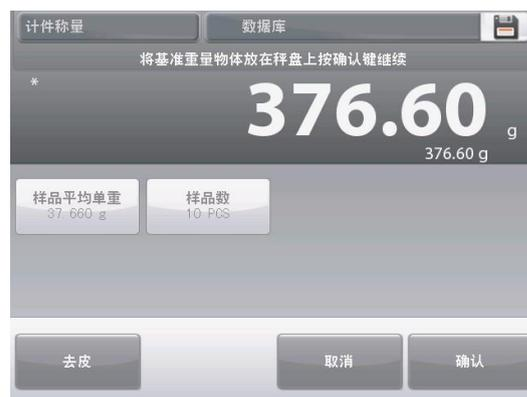
例：主螢幕顯示計件結果為10件，基準為天平計算得出的樣品平均單重
