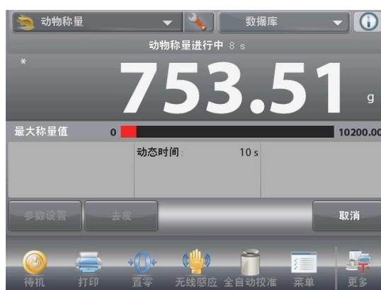
在迴圈結束後，移除樣品，天平自動返回主螢幕（在10秒延遲之後）。
