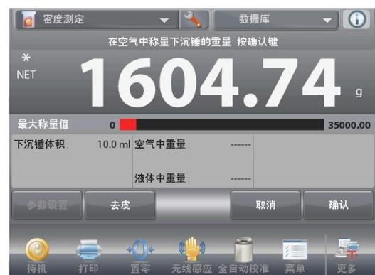
當測試結束後，液體樣品的密度在螢幕上以 $\text{g/cm}^3$ 為單位顯示（以及空氣中重量和液體中重量）。
