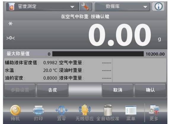
**3個步驟的第2步**——在空氣中稱量浸油樣品。
