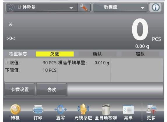
4.2.3.1 參數設置:如欲使用計件稱量的檢重計件模式，需設置上
