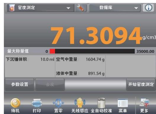
4.10.6 測試多孔材料的密度
