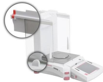
打開安裝鎖（頂部），將側門同時插入頂部滑槽和底部槽。鎖定鎖緊裝置。
