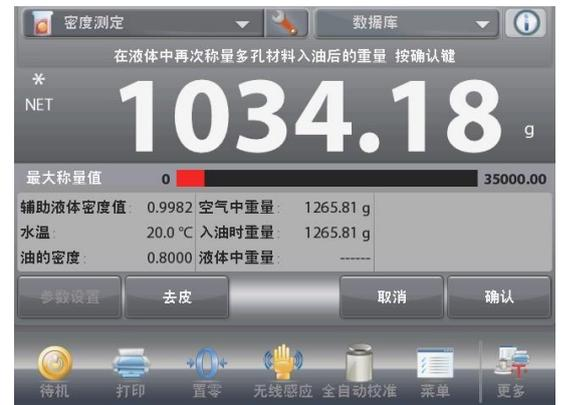
當測試結束後，樣品的密度在應用螢幕上以 $\text{g/cm}^3$ 為單位顯示（以及空氣中重量、浸油時重量和液體中重量）。
