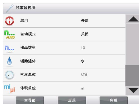
移液器校正應用設置（預設值採用粗體顯示）
