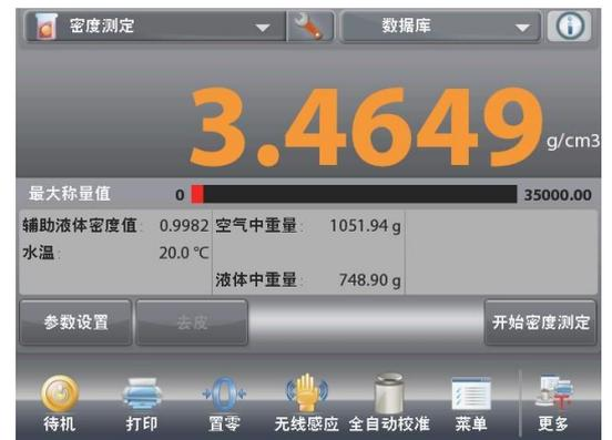
當測試完畢，螢幕上採用 $g/cm^3$ 顯示樣品密度（以及空氣中重量和液體中重量）。
