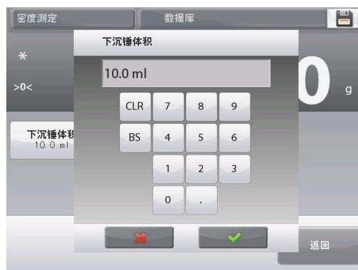
**2個步驟的第1步——**在空氣中稱量下沉錘的重量。
