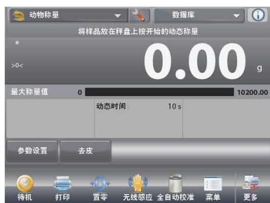
將樣品放置在秤盤上。動物稱量自動啟動。
