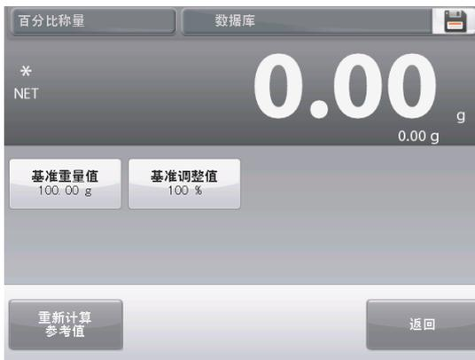
目前的基準重量值顯示在設置螢幕上。要直接調整基準重量點選基準重量值按鈕。
