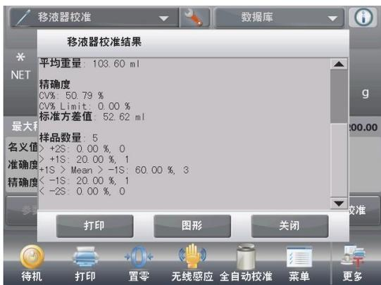
當所有樣品的重量已記錄，移液器校正結果螢幕會自動顯示。
