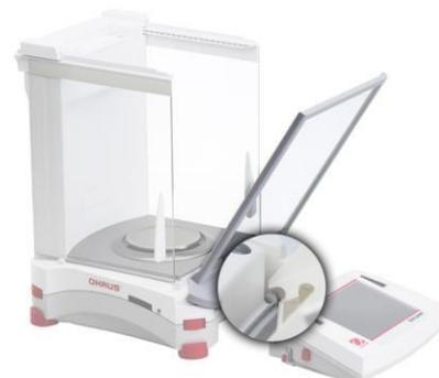
按下按鈕將螢幕從稱量基座上分離。將前門底部的圓形鉤插入基座卡槽，推動前門至垂直。
